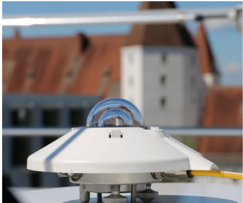
Solarstrahlungsmessung am Dachlabor der THl vor historischer Kulisse in Ingolstadt. Quelle: THl
